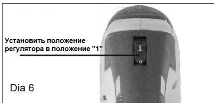
**⚠ Внимание!** Частота ходов зависит от давления на инструмент. Не перегружайте машину. При низкой частоте ходов (позиция регулировочного колеса 1 или 2) не пилите дерево, толщина которого превышает 10мм или металл, толщиной более 1мм.
