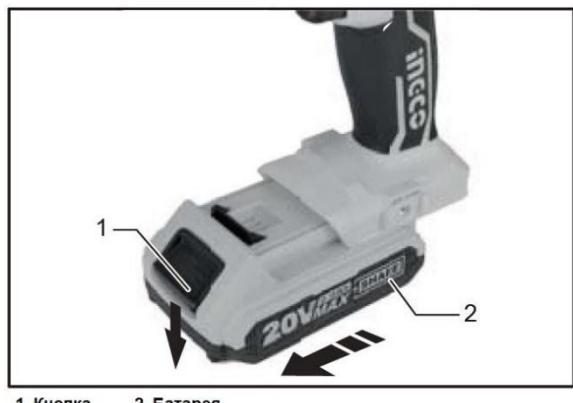
Чтобы извлечь батарею, сдвиньте её из инструмента, нажимая кнопку на передней части батареи.
